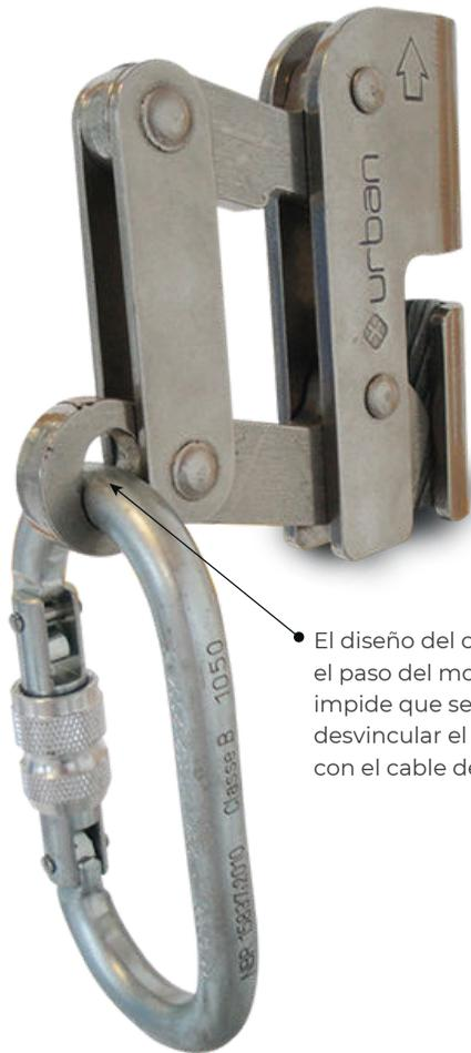
El diseño del ojo para el paso del mosquetón impide que se pueda desvincular el salvacaídas con el cable de acero.
